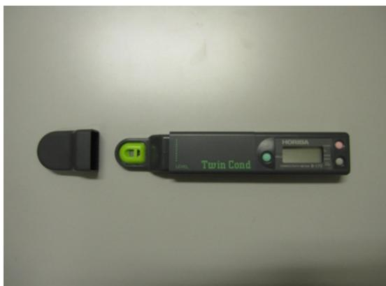
堀場製作所製の電気伝導度セル
