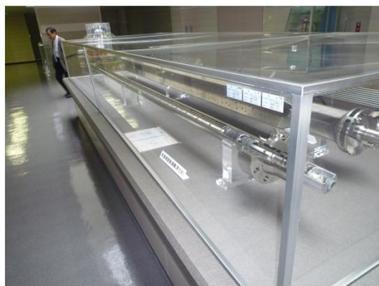
制御棒駆動機構
